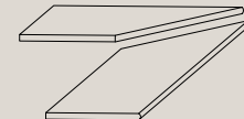
GRADINO ANGOLO ESTERNO BORDO CON TORO EXT. CORNER STEP TREAD ▲ 30x60 (12"x24") RT 20 mm
